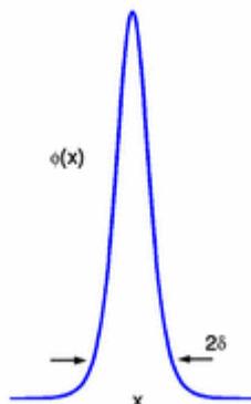
**Figura 3.** La figura muestra un ejemplo de la región en que las fuerzas afectan al fluido. Si  $x=(x,y,z)$  representa un punto en la membrana, la función mostrada representa la magnitud de la fuerza en ese punto. El grosor de la función es controlado con un parámetro  $\delta$ .
